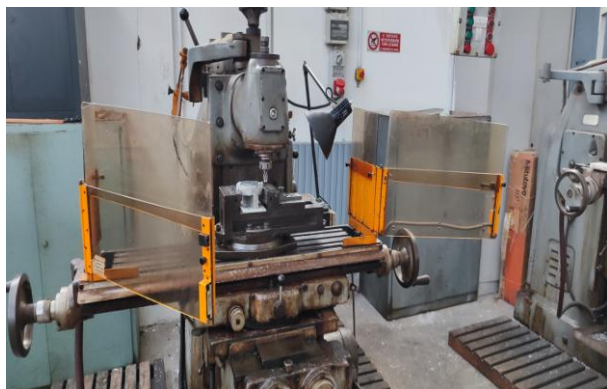
fresa con protezioni fisse e pulsante d'arresto
