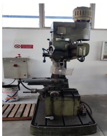
trapano a colonna con protezioni fisse
