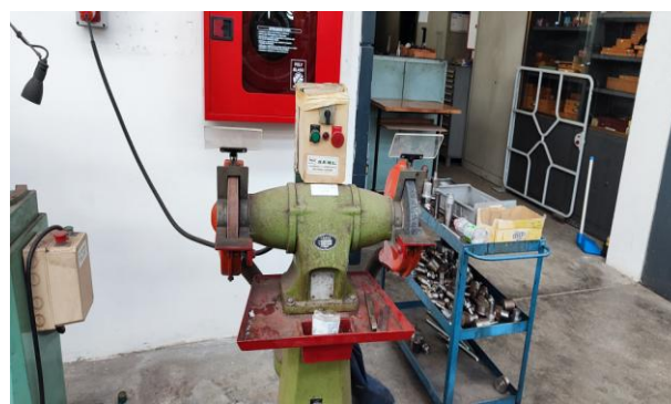
mola con protezioni fisse e pulsante di arresto
